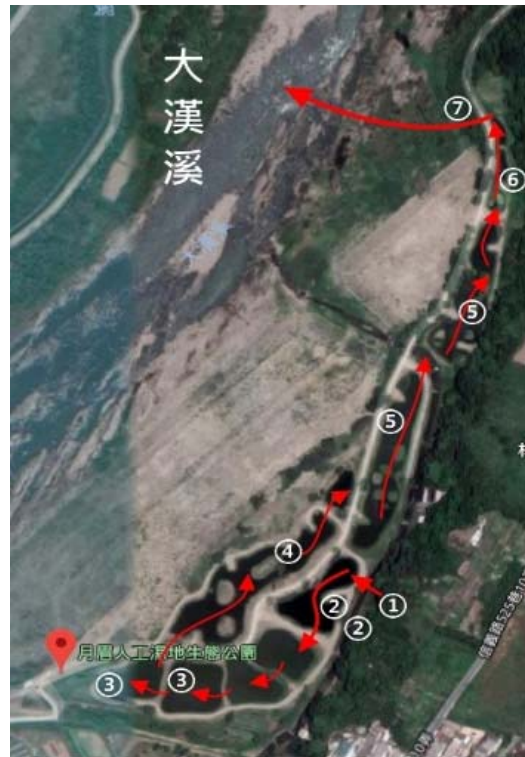
圖六：月眉人工濕地水質淨化流程圖 (資料來源：本研究自行整理)
